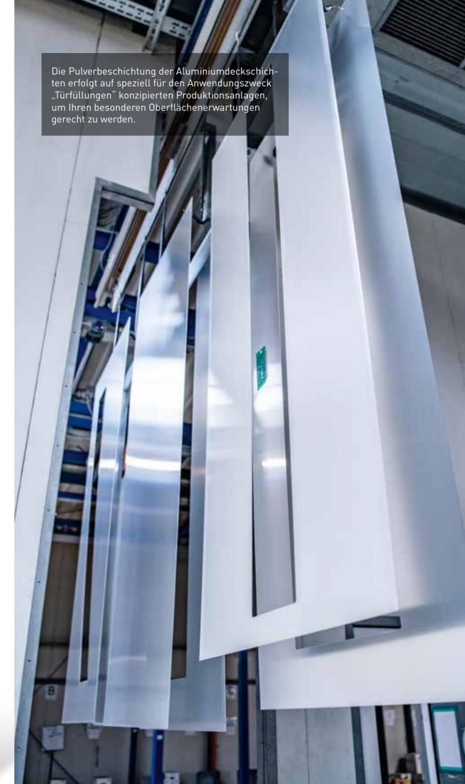
Die Pulverbeschichtung der Aluminiumdeckschichten erfolgt auf speziell für den Anwendungszweck „Türfüllungen“ konzipierten Produktionsanlagen, um Ihren besonderen Oberflächenerwartungen gerecht zu werden.
